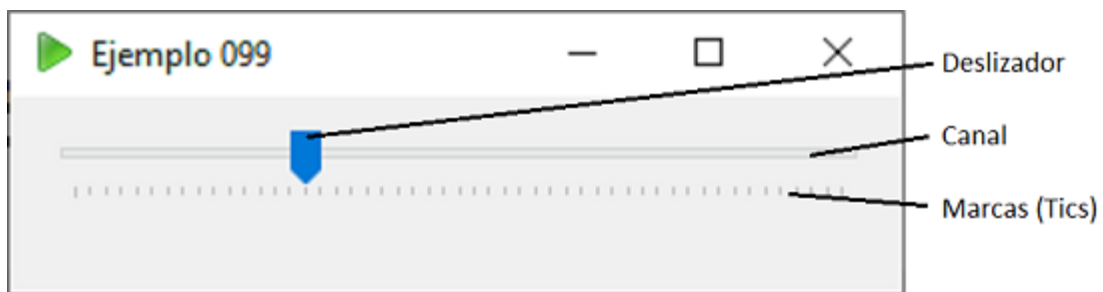
Partes de un trackbar
